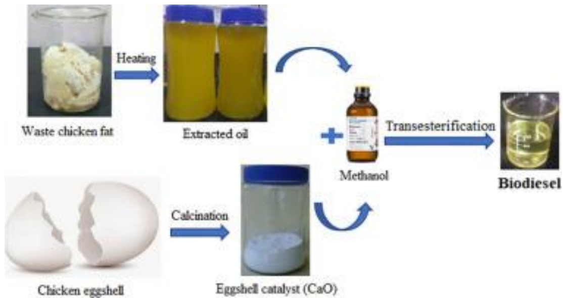
Figura 7. Producción de biodiesel a partir de grasa de pollo de desecho usando la cascara de huevo de gallina para lograr un catalizador de micro cáscara de huevo.
