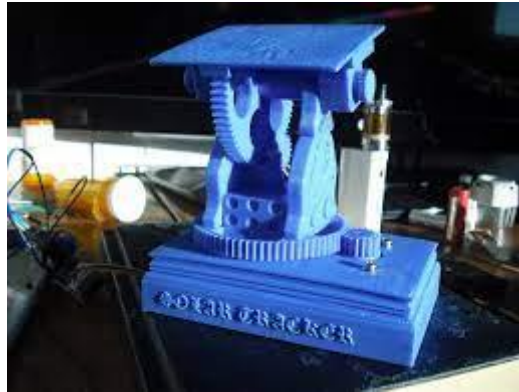
Fig.9, diseño seguidor solar impreso en 3D a escala, fuente cults3d
