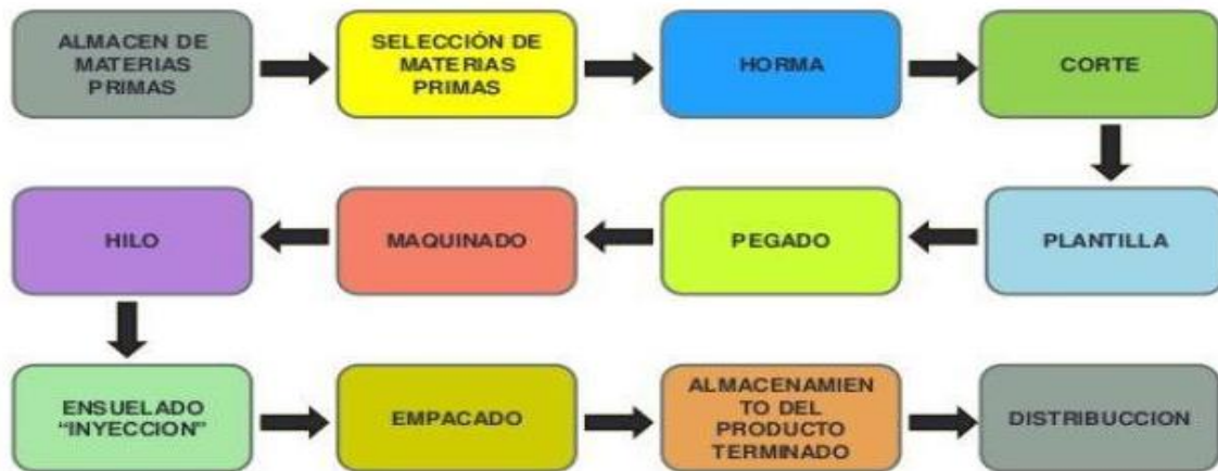
Diagrama Proceso de fabricación del calzado:
