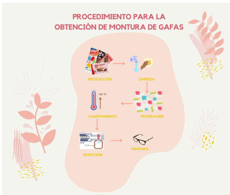
Figura 22. Procedimiento para la obtención de la montura para gafas
