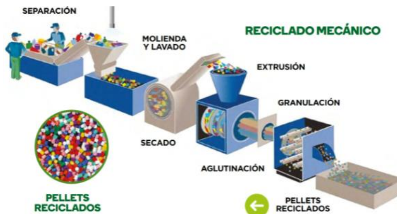
Figura 10. Proceso de reciclaje mecánico
