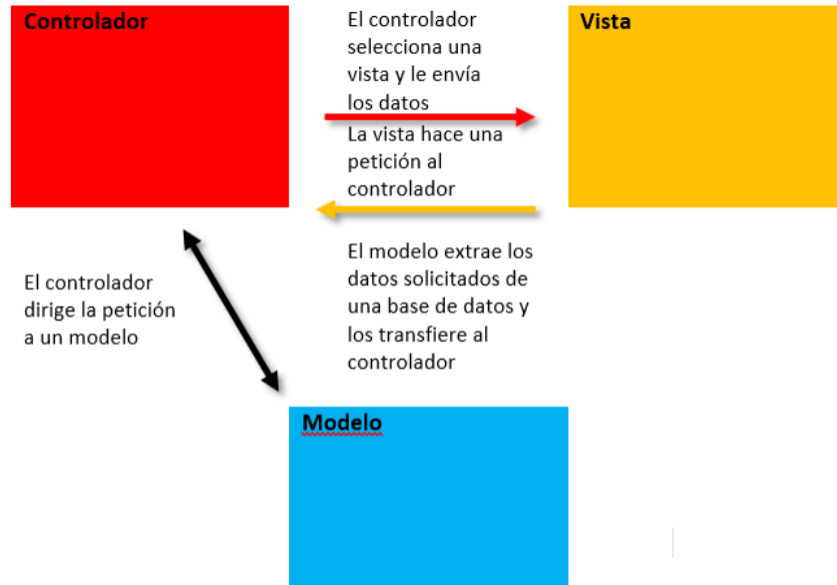
Figura 3. Esquema arquitectura Modelo Vista Controlador (MVC), tomada de Digital Guide IONOS.
