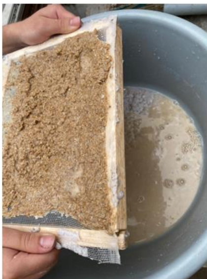
Imagen 1. Extracción de humedad
