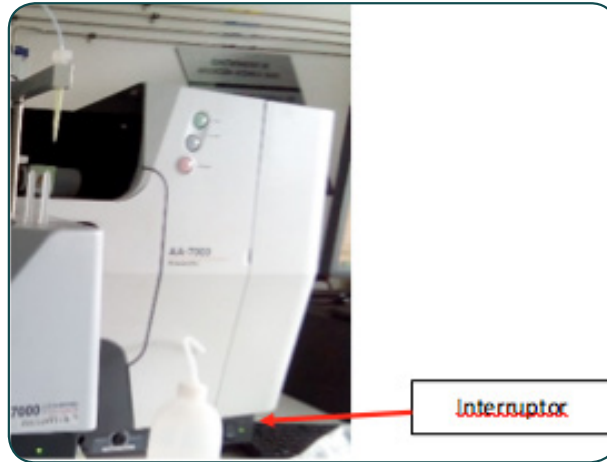
Figura 13. Posición del interruptor del espectrofotómetro.
