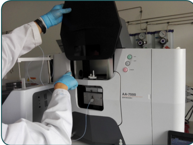
Figura 18. Posición del interruptor del espectrofotómetro.
