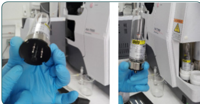
Figura 29. Detalle del carrusel de lámparas del espectrómetro.
