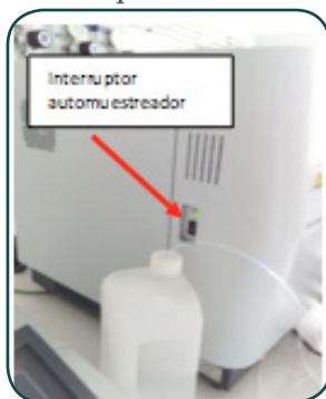
Figura 46. Posición del interruptor del automuestreador.
