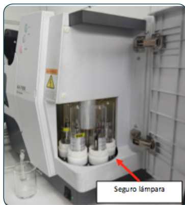
Figura 28. Detalle del carrusel de lámparas del espectrómetro.
