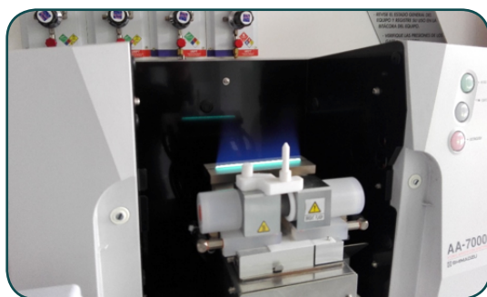
Figura 77. Imagen de la llama de Acetileno-aire para la lectura de zinc en modo llama.
