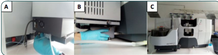
Figura 16. Detalles de ajuste de la posición del automuestreador ASC para
