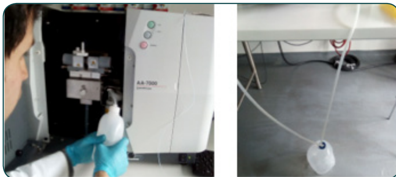
Figura 8. Llenado del recipiente de drenaje. Verificar que haya rebose del líquido.
