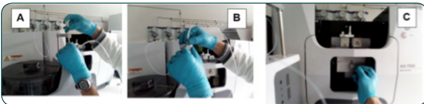
Figura 17. Detalles del ajuste de la manguera de succión de muestra en modo llama.
