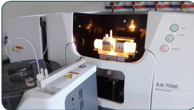
Figura 81. Imagen de la lectura de cobre en el instrumento por modo horno de grafito.
