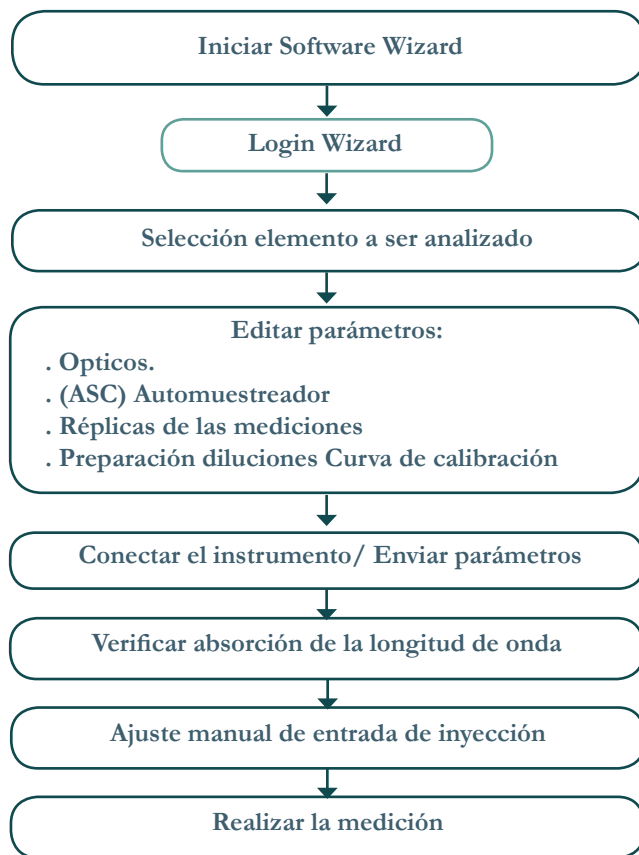
Figura 49. Diagrama de flujo del encendido del instrumento.
