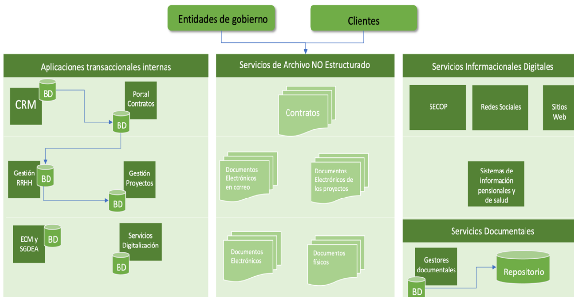
Figura 53 Diagrama conceptual arquitectura de aplicaciones y datos AS-IS
