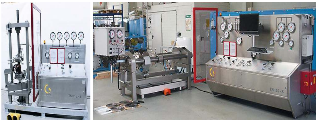
Imagen 5. Banco de trabajo para reparación y mantenimiento de válvulas
