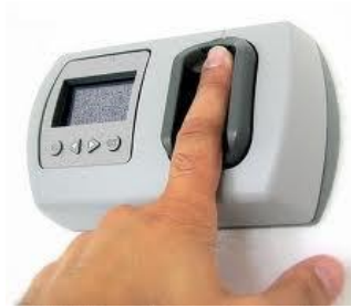
Ilustración 14: Imagen ejemplo de un sistema biométrico con lector de huella digital. Fuente: http://www.sistemasbiometricos.cl/web/
