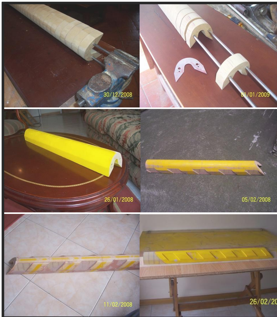
Foto 6. Secuencia de construcción del modelo patrón.
