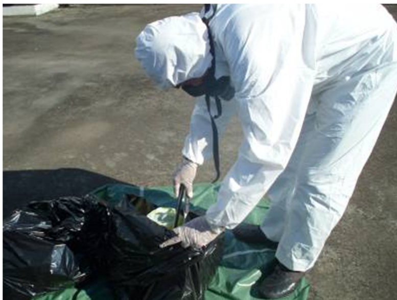
Foto 19. Procedimiento de caracterización de residuos
