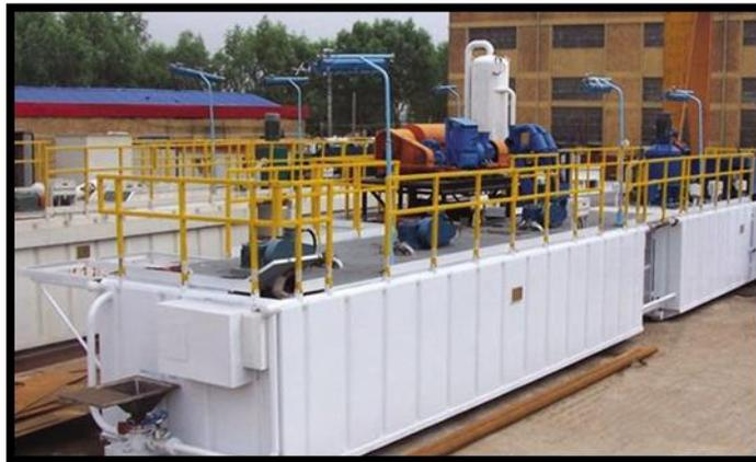
Nota: Equipo Unidad de Dewatering. Recuperado de <http://www.jerehoilfield.com/spain/products/Centrifuges.shtm>.2012
