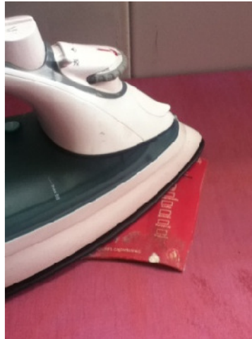
Ilustración 7: Prensado de láminas para conformación de material compuesto Fuente: Adriana Jiménez, 2013
