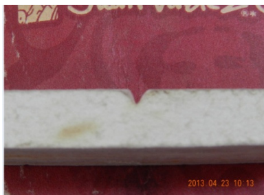
Ilustración 26: Probeta prueba de Impacto Charpy con muesca de 45° - Longitudinal Fuente: Adriana Jiménez, 2013
