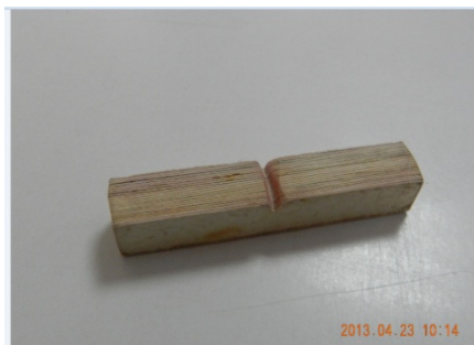
Ilustración 25: Probeta prueba de Impacto Charpy con muesca de 45° - Transversal
