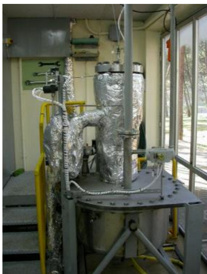
Gráfico 28 - Reactor para Pretratamiento Fisicoquímico
