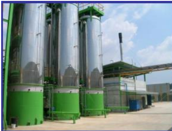
Gráfico 32 - Reactor para Hidrólisis Enzimática y Fermentación Simultáneas
