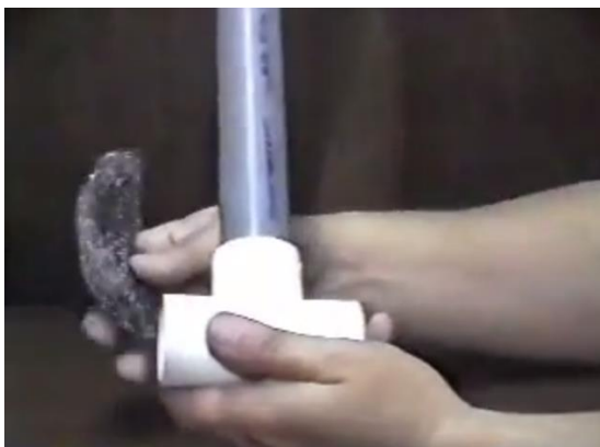
Figura 25. Inserción de la esponjilla metálica en válvula de seguridad para el Biodigestor Taiwán o Estructura Flexible
