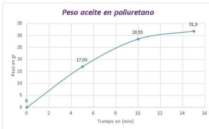
Ilustración 9. Gráfico peso vs. tiempo, absorción del poliuretano en aceite. Fuente: Elaboración propia
