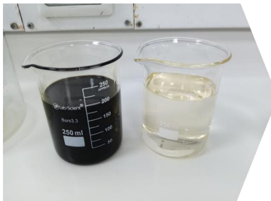
Ilustración 6. Materias primas del poliuretano: Polio e isocianato. Fuente: Elaboración propia
