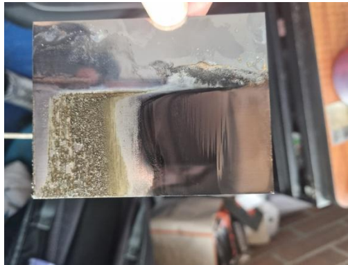
Figura 15. Electrodeposición de cromo en lámina de hierro.
