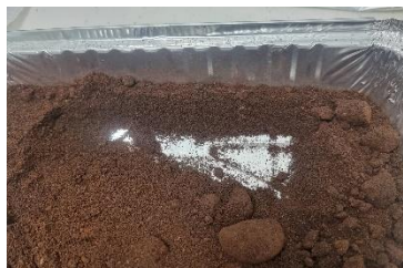
Figura 7. Secado a 60°C por 2 horas de la borra de café
