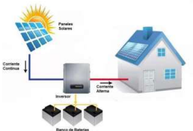
Ilustración 13 Sistema Solar Fotovoltaico Baterías
