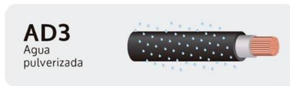
Fig. 14: Cableado protección AD3
