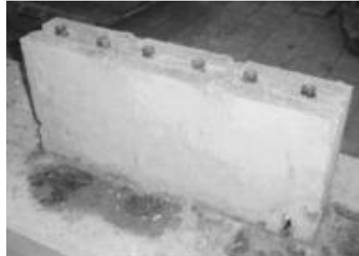
Ilustración 10 Ejemplo de ladrillo con material de envases PET
