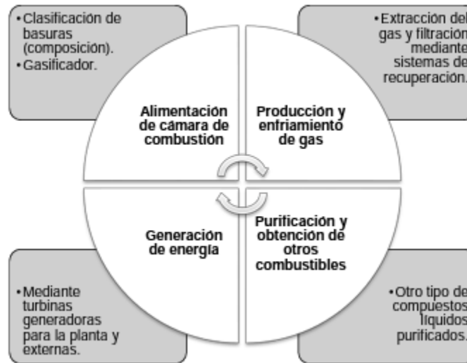
Figura 4. Descripción del Proceso de Gasificación por Plasma
