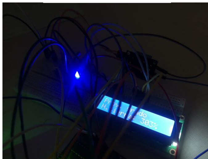
Figura 12: Sistema de detección de presencia de agua.
