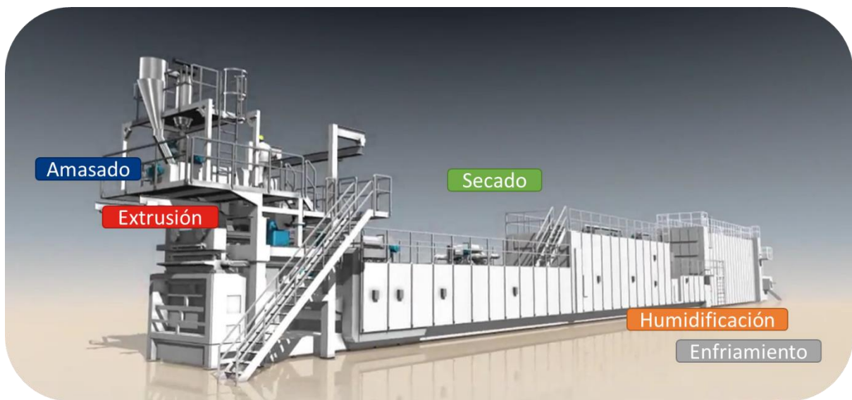
Figura 2. Principales operaciones en la producción de pasta línea FAVA A
