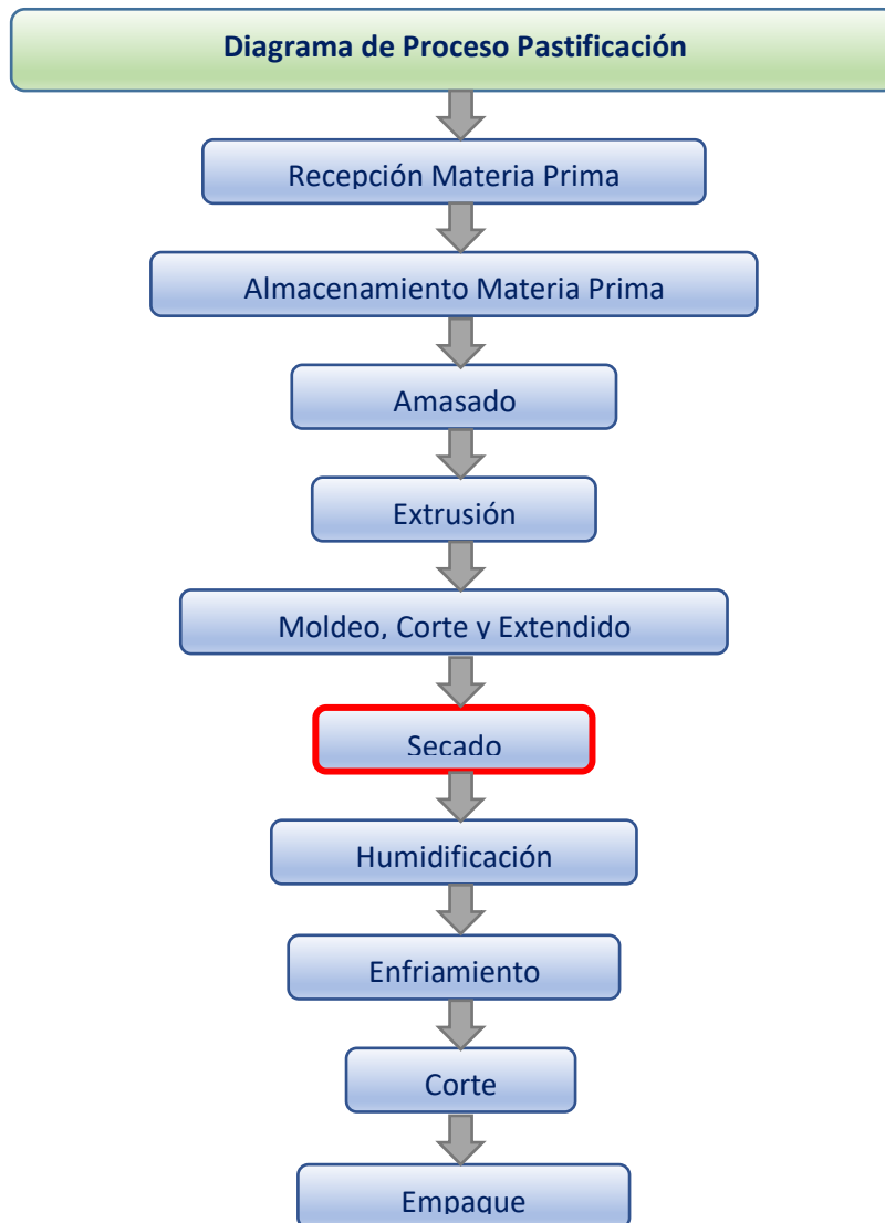
Figura 3. Diagrama de proceso de la fabricación de pastas alimenticias
