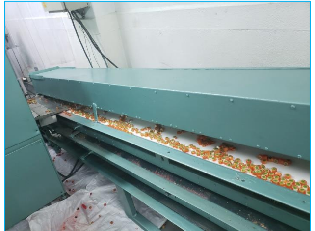
6. Paso del caramelo al túnel de frío
