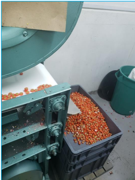
7. Paso del caramelo cortado y terminado a canasta
