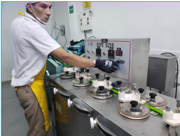
3. Inspección de la velocidad de los discos
