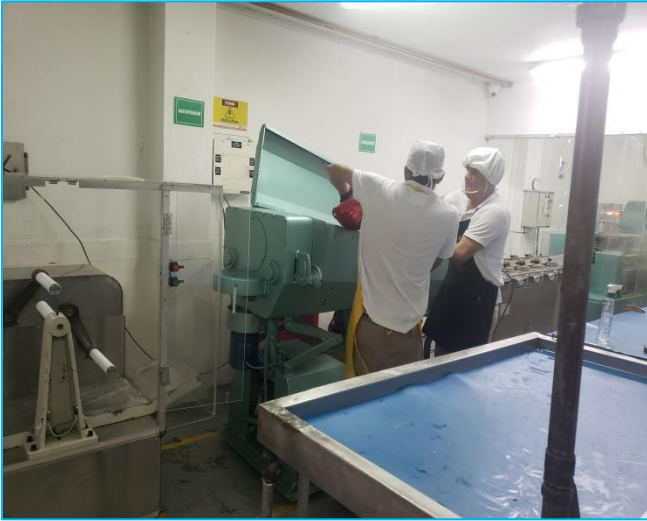
1. Paso del caramelo armado al bastoneador
