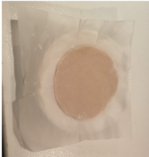
Figura 3. Prototipo 1: material para la elaboración de platos con cáscara de huevo y almidón
