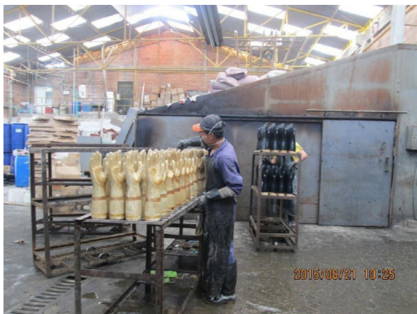
Figura 5. Proceso de enfriado y secado de guantes de látex
