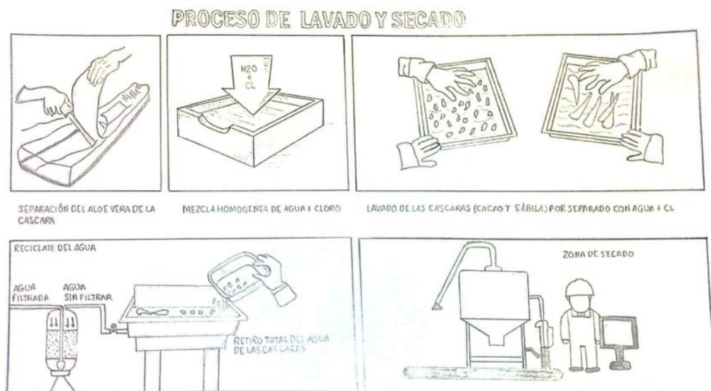
Figura 18. Proceso de separación, lavado y secado. Fuente: Elaboración propia.
