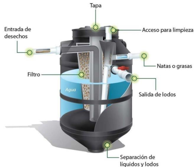
Figura 3. Partes del biodigestor.
