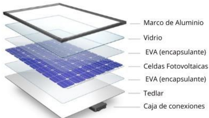
Figura 16. Estructura de un panel solar fotovoltaico
