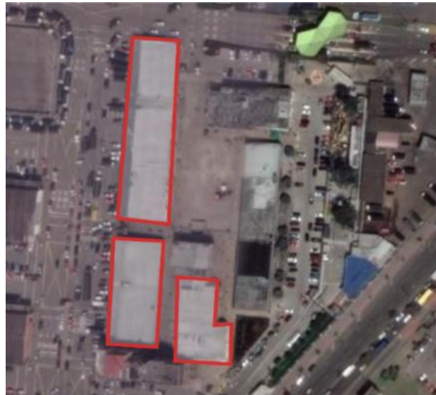
Figura 20. Cubiertas aptas para la instalación de los paneles solares.
