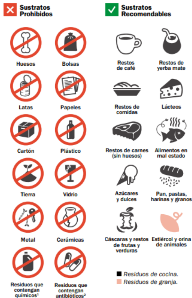
Figura 8. Sustratos para la generación de Biogás
