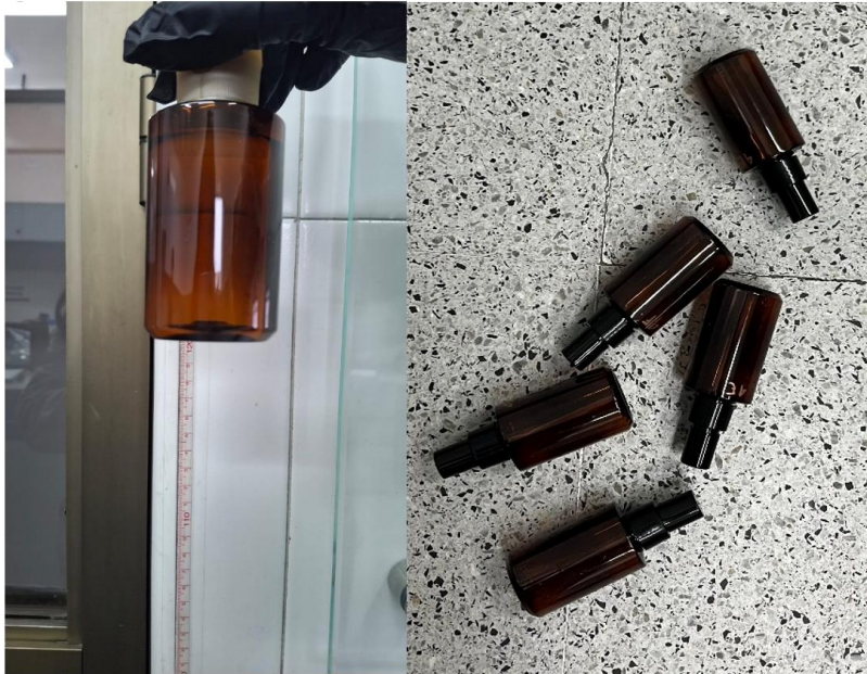
Figura 11. Prueba funcional, caída libre a 120 cm.
