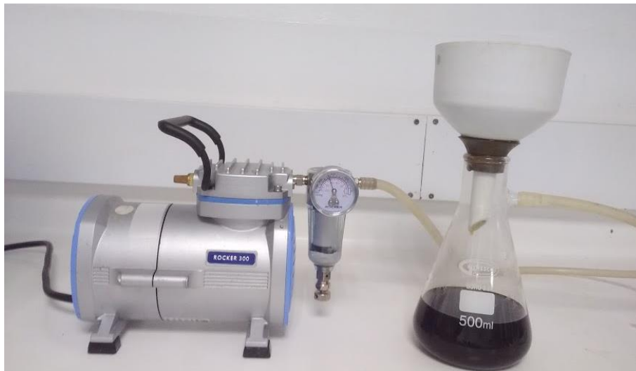
Ilustración 9 - Filtración licor negro, Fuente: Creación propia.
