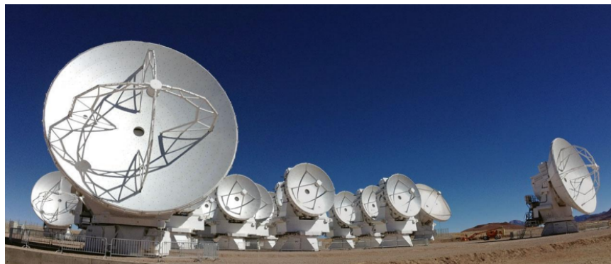
Figura 20. Arreglo de antenas parabólicas.
