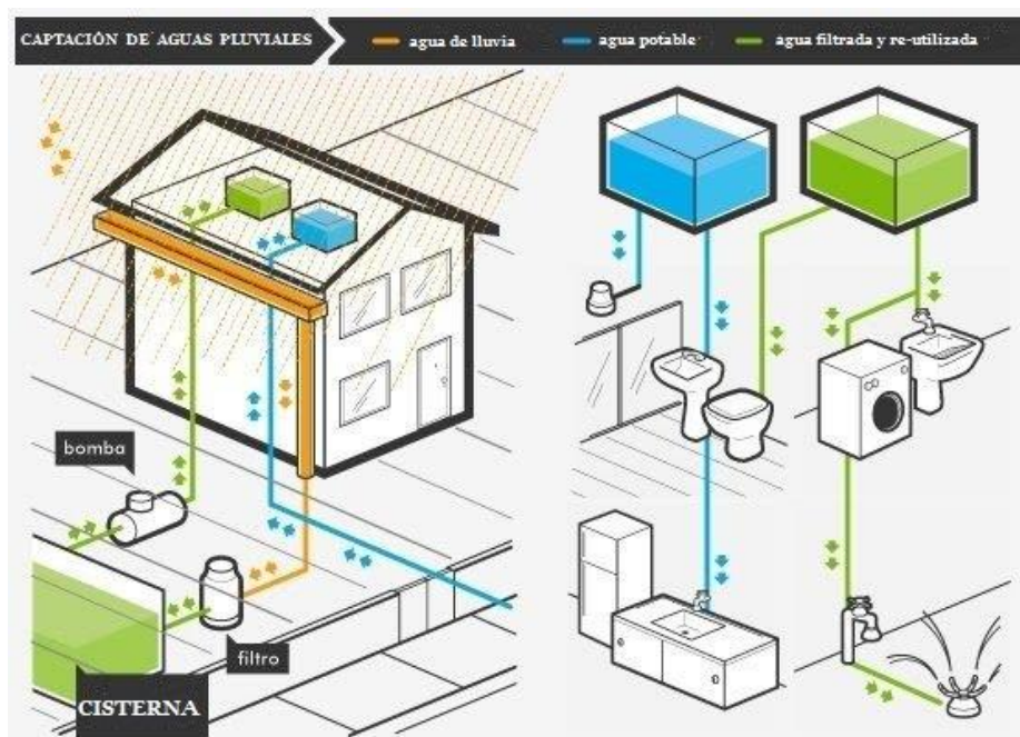
Ilustración 17. Esquema de almacenaje y distribución aguas lluvia.
