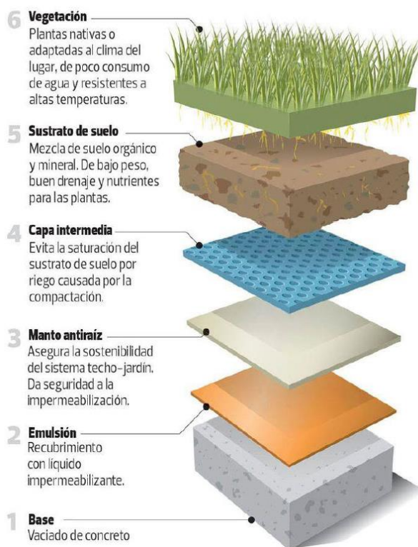
Ilustración 19. Capas principales en un techo verde
