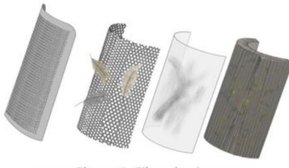
Figura 20. Filtro de Aire.
