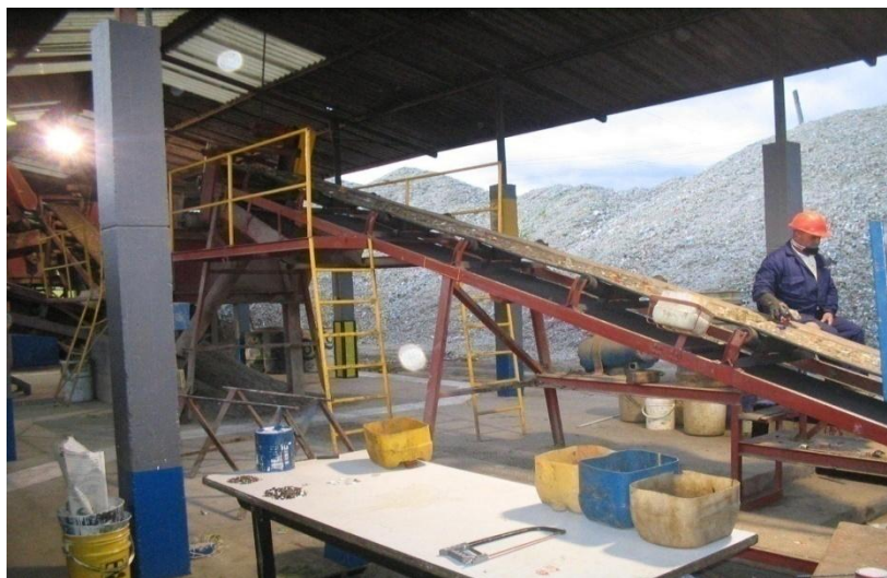
Figura 8. Banda transportadora N° 1. Separación de contaminantes
