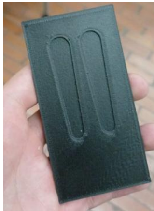
Ilustración 4 Molde virgen para la cuchara nucita en fibra de carbono
