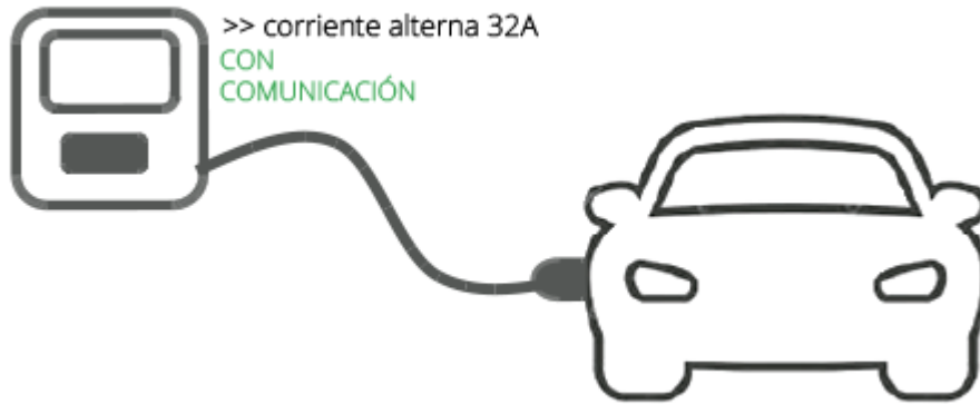
Ilustración 20. Modo de recarga 3
