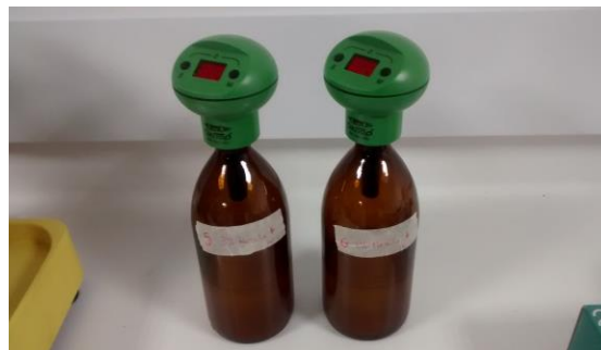
Fotografías 2, 3 y 4. Botellas respirométricas durante preparación de prueba.
