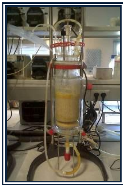
Foto 2. Bioreactor Fase 1. Hidrólisis y Solubilización de la FORSU
