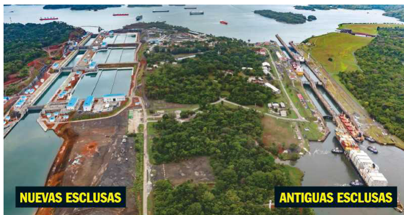
Figura 3. Comparativo entre las antiguas y las nuevas esclusas
