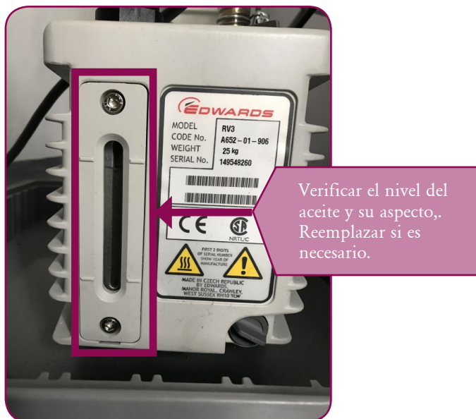
Figura 4. Nivel de aceite de la bomba.
