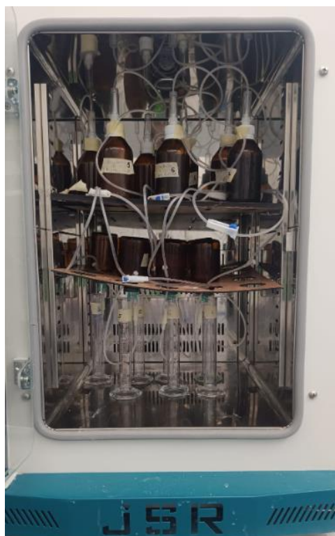
Figura 4. Montaje de los biodigestores
