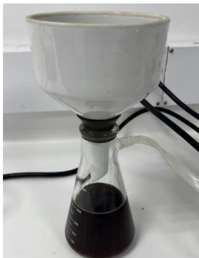
Ilustración 11. Montaje filtración al vacío.
