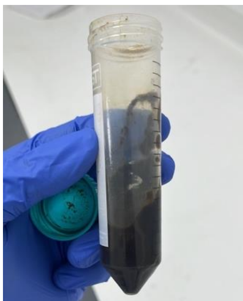
Ilustración 10. Lodo formado durante la filtración.
