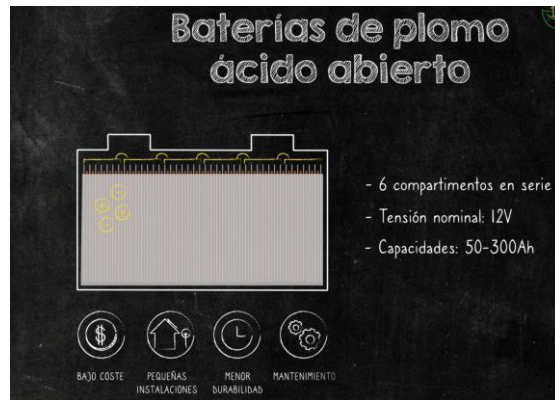
Figura 14. Partes de la batería de plomo-acido abierto
