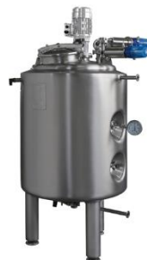
Figura 12 Tanque de fermentación
