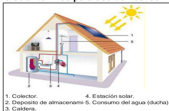
Figura 8. Sistema solar térmico para uso doméstico
