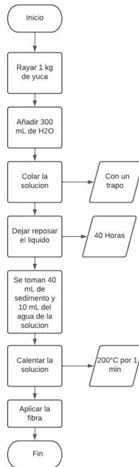
Ilustración 7. Procedimiento de obtención de almidón de yuca
