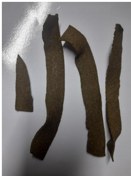
Ilustración 11. Cuero con almidón de yuca secado en aire
