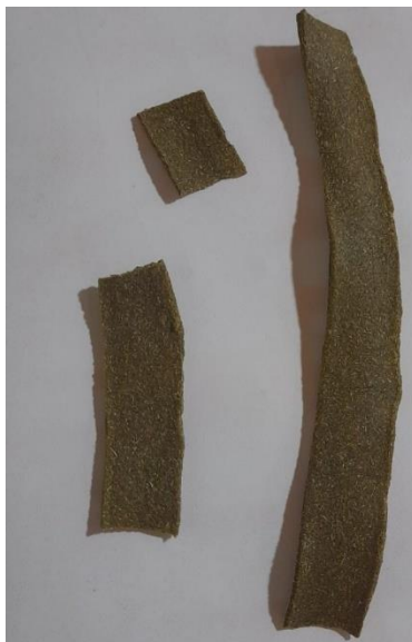
Ilustración 10. Cuero con almidón de yuca secado en horno
