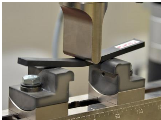
Ilustración 1. Método para rigidez del plástico Fuente, (Vázquez et al., s/f)
