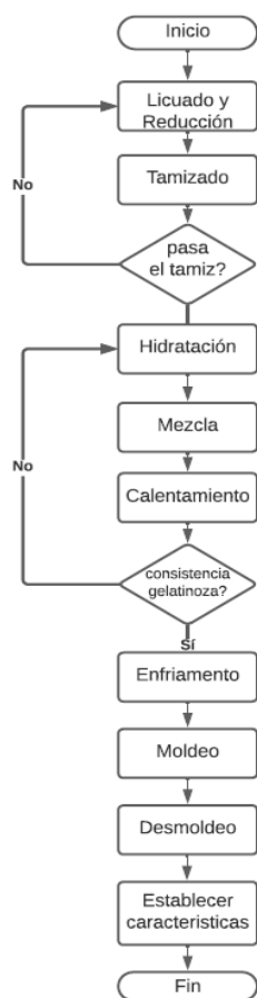
Ilustración 12. Proceso elaboración de Bioplástico Fuente, Elaboración propia.
