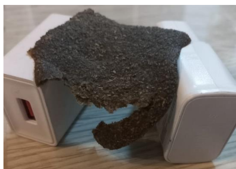
Ilustración 29. Muestra 2, sin ejercer fuerza presentaba deformaciones. Fuente, Elaboración propia.
