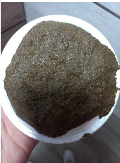
Ilustración 23. Muestra puesta al sol durante 48 horas Fuente, Elaboración propia.
