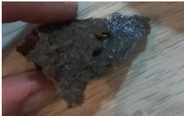
Ilustración 30. Muestra 1. Se deforma con facilidad Fuente, Elaboración propia.
