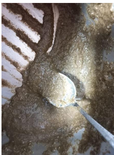
Ilustración 22. Mezcla de almidón, agua, vinagre y glicerina gelatinizado Fuente, Elaboración propia.
