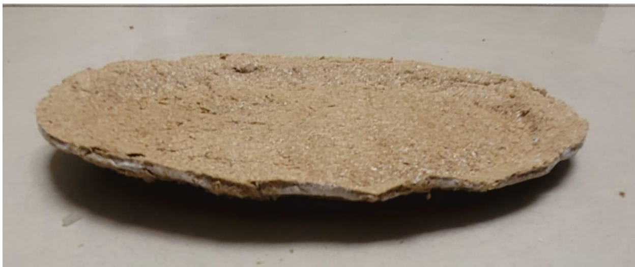
Figura 32. Envase biodegradable a partir de molde #1.
