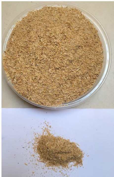
Figura 3. Cascarilla molida con malla de 4 micras. Fotografía propia
