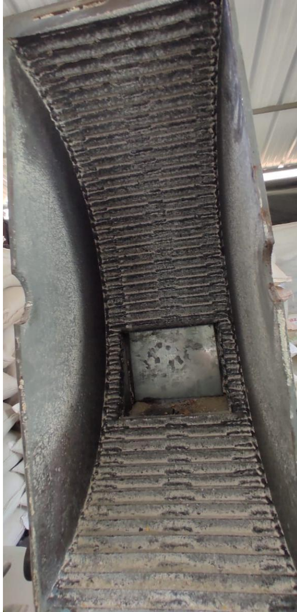
Figura 16. Vista interior de molino de martillos. Toma de fotografía propia.
