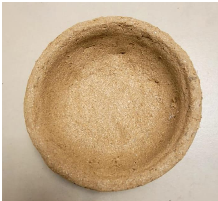
Figura 29. Prueba de acción con aglutinante artificial más cascarilla de 1 micra, con un tiempo de 50 minutos a 200°C
