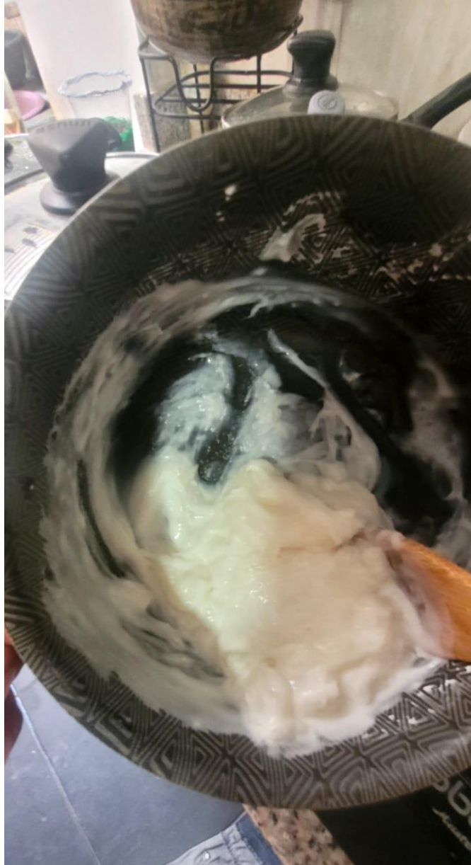
Figura 24. Prueba #2 de aglutinante, donde la mezcla se compone de 60 gramos de almidón de yuca, 40 gramos de almidón de maíz y 400mL de agua
