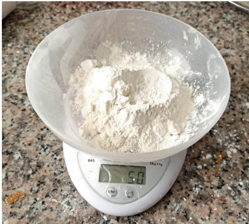
Figura 34. Mezcla con aglutinantes con 20 gramos de xantana, 20 gramos maíz y 10 gramos de yuca
