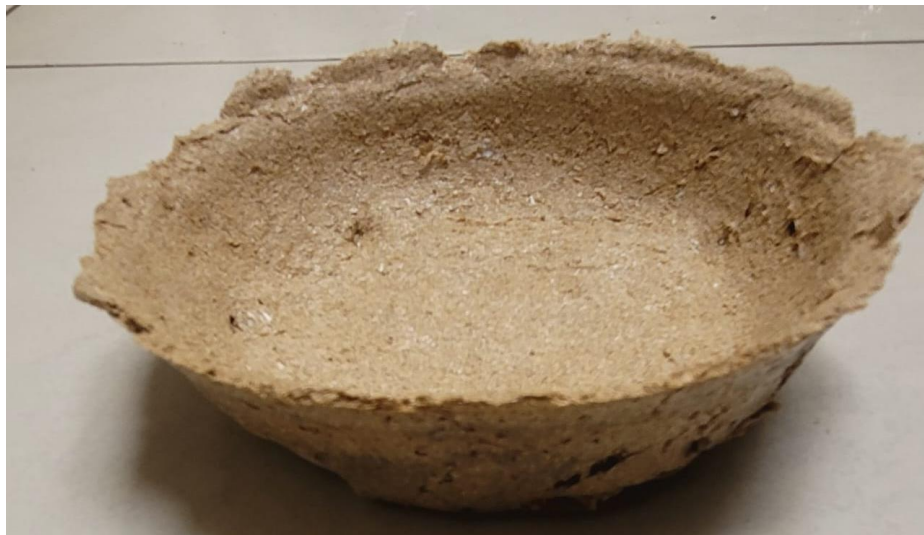
Figura 31. Envase biodegradable resultante a partir de molde #3. Superficies irregulares y daños al momento de desmoldar
