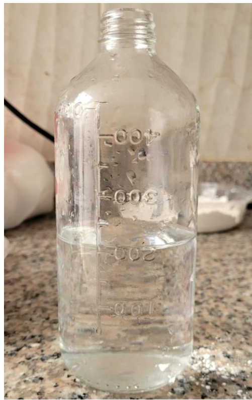
Figura 39. Mezcla de 200 gramos de cascarilla de 1 micra para prueba #4
