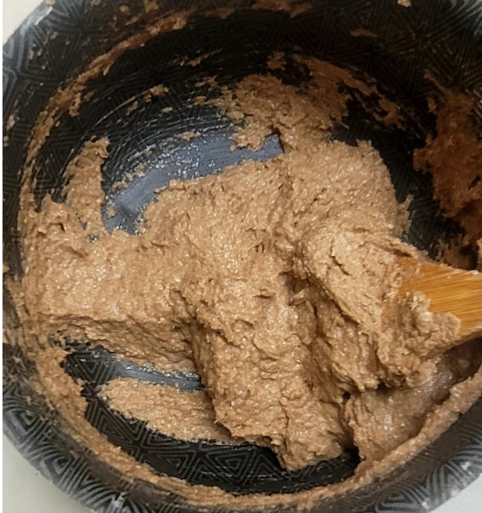
Figura 25. Mezcla con aglutinante prueba #2 adicionando a la mezcla inicial más 160 gramos de cascarilla de tamaño de 1 micra
