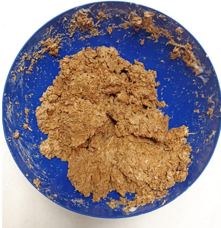
Figura 37. Mezcla resultante, donde se evidencia que no es apta para llevar a moldes
