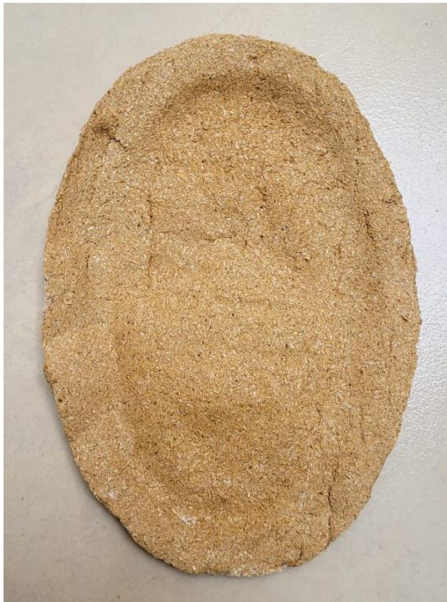
Figura 32. Envase biodegradable a partir de molde #1.
