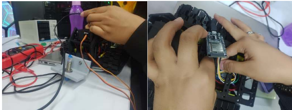
Figura 7. Conexión de componentes a la tarjeta de desarrollo ESP32
